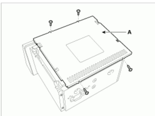
3. 拧下螺钉(2个)后,拆卸控制器的面板(A)。
