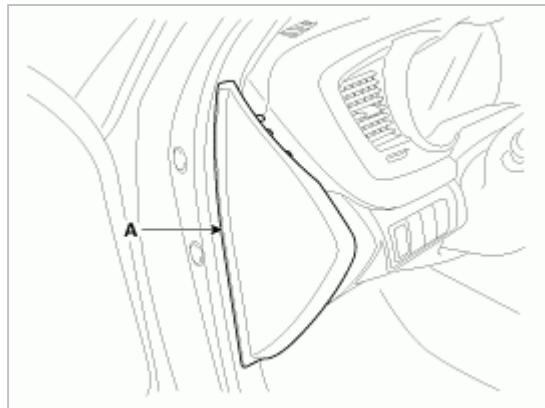
4. 拧下仪表板下板固定螺钉,拆卸下板(A)。
