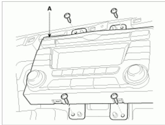
12. 分离音响控制模块连接器和导线(A),完全拆卸音响控制模块。
