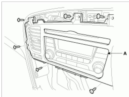
11. 拧下固定螺钉后,拆卸音响控制模块(A)。
