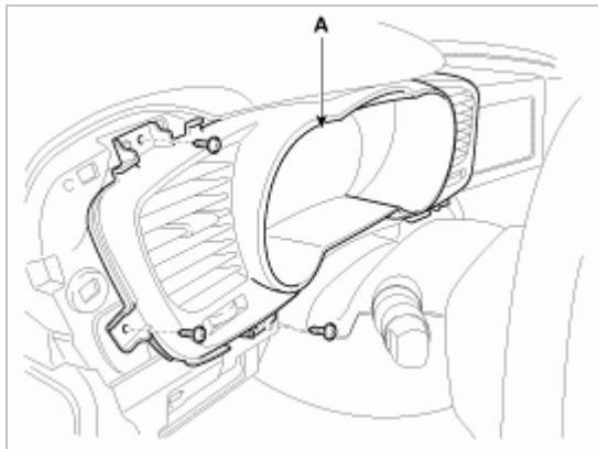
8. 拧下螺钉后,拆卸空调控制模块(A)。
