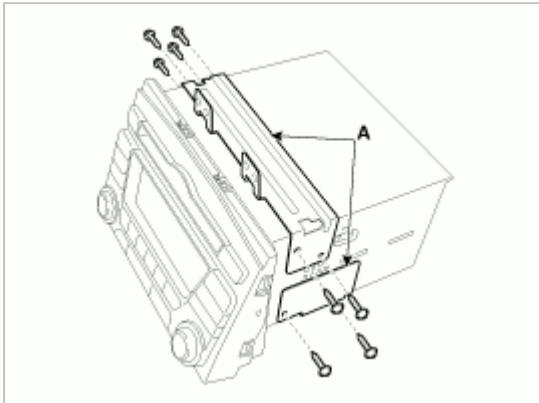
2. 拧下控制器上的螺钉(4个),拆卸顶盖(A)。
